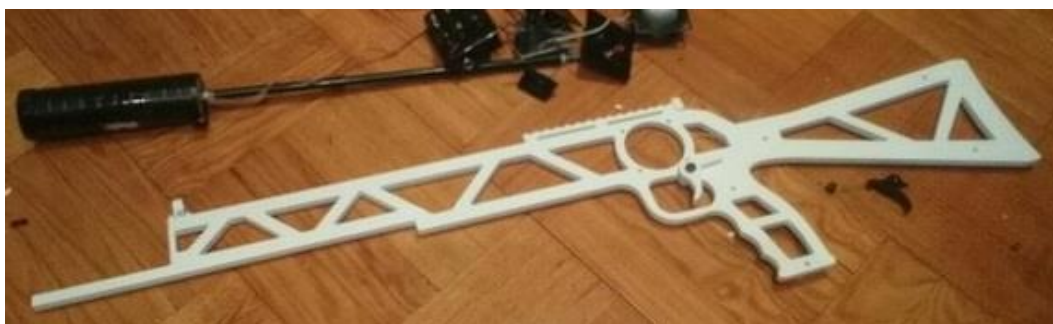
Рис. 15. Прототип каркаса для навески модулей оборудования
