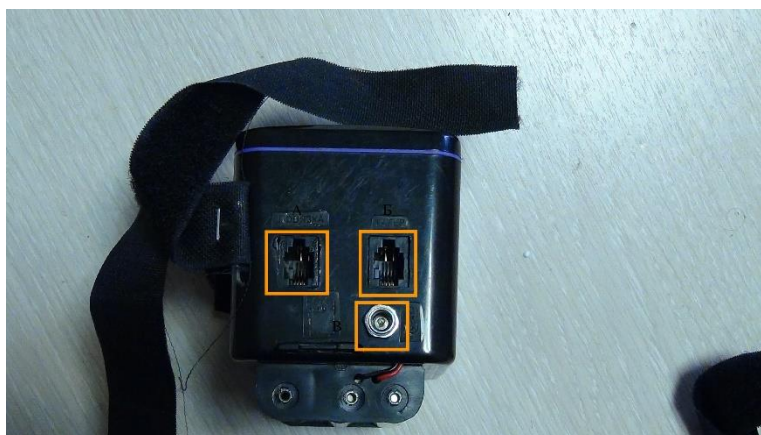
Рис. 4. Фото модуля обработки событий (А - вход для коннектора повязки, Б - вход для коннектора повязки, В - вход для коннектора зарядки)
