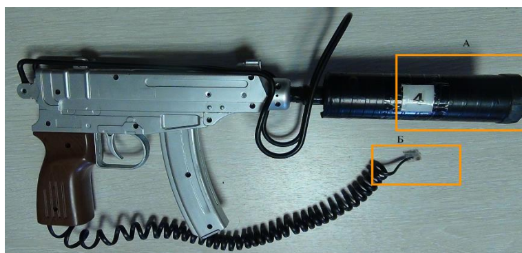
Рис. 2. Фото оружия (А -передатчик инфракрасного сигнала, Б - коннектор, подключаемый к главному модулю)
