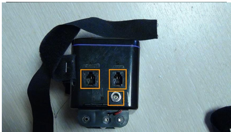
Рис. 3. Фото повязки (А - приемник инфракрасного сигнала, Б - коннектор, подключаемый к главному модулю)
