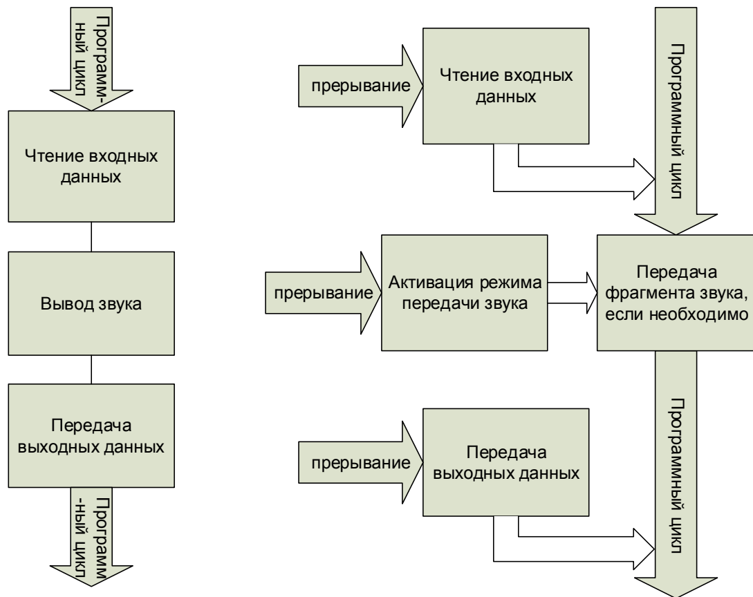
Рис. 9. Слева – классическая схема обработки данных, справа – с использованием прерываний
