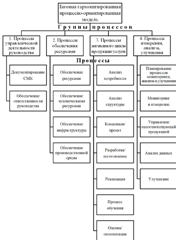
Рис. 2. Гармонизированная процессно-ориентированная модель на основе стандартов ИСО 9001 и ИСО/МЭК 19796-1
