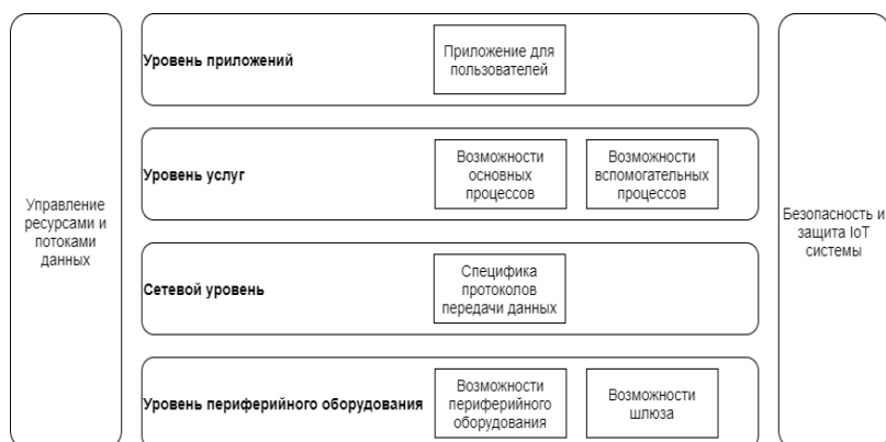
Рисунок 1. Многоуровневая эталонная схема интернета-вещей
