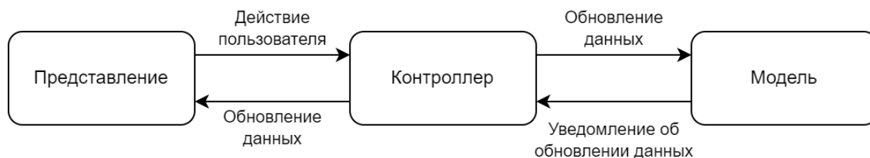
Рис. 1 – Схема взаимодействия компонентов архитектурного шаблона Модель-Представление-Контроллер Cocoa
