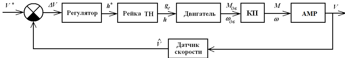
Рис. 1. Функциональная схема контура стабилизации скорости АМР
