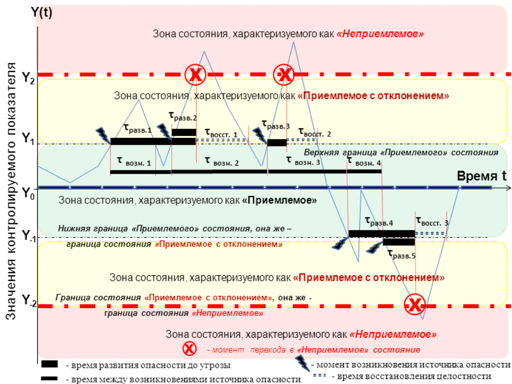
Рис. 1 – Элементарные состояния контролируемого показателя УВМП во времени и временные характеристики для прогнозирования рисков
